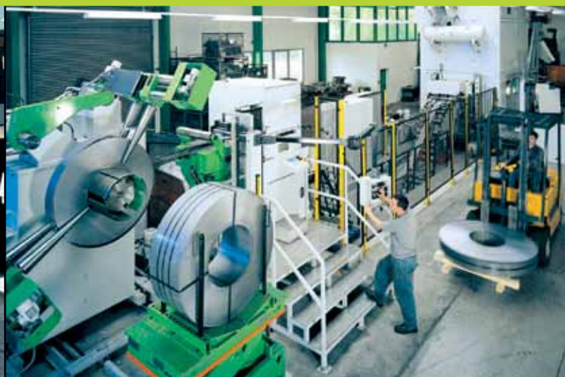
Koncentrált erő: a modern préspark, akár 630 tonna nyomóerővel
